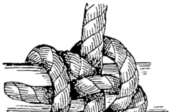
FIG. 51 A.—Roband hitch (front).
